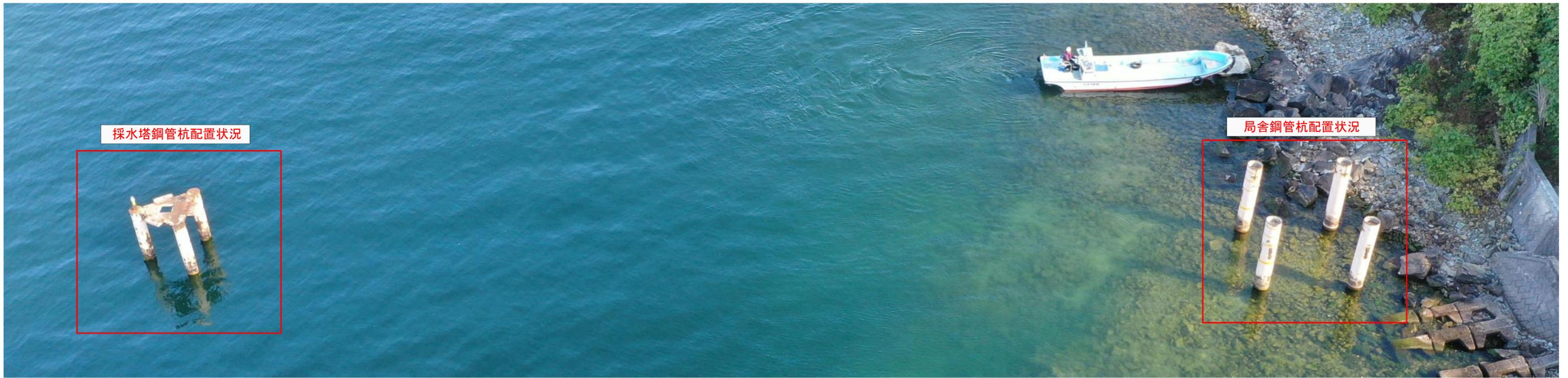
採水塔鋼管杭配置状況
