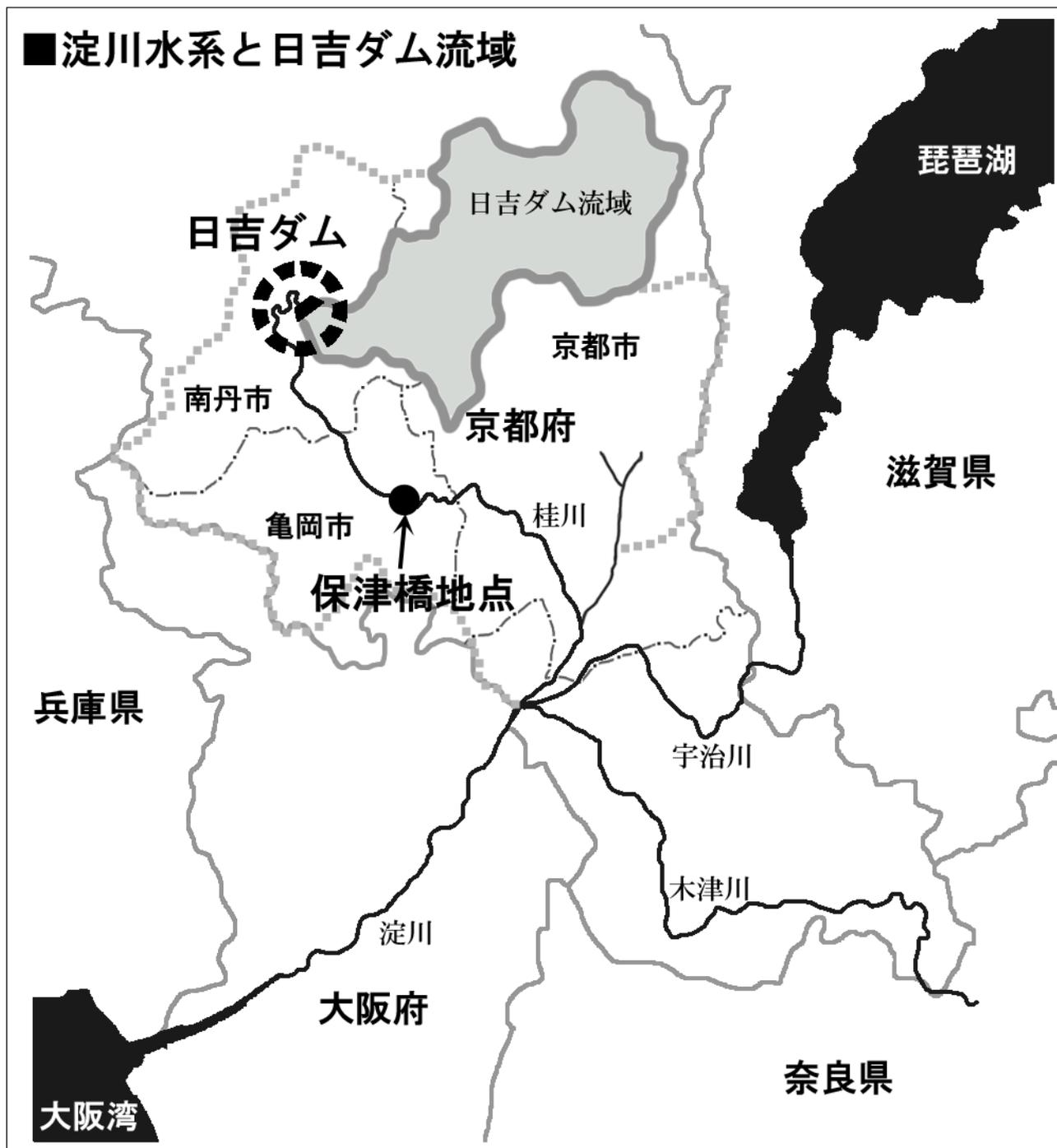
・日吉ダム最大流入時に約98%を貯留、ダム下流の河川水位を低減
