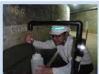
堤体内での漏水量の測定
