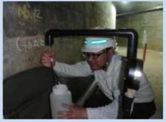
堤体内での漏水量の測定
