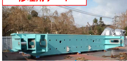
修理用ゲート
