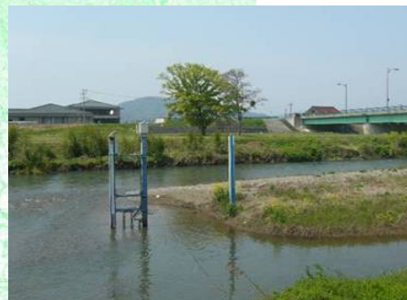
福橋(水位、濁度・水温観測)
