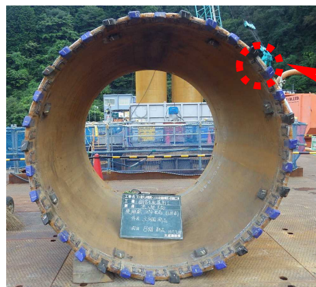
先端のビット摩耗・欠損
