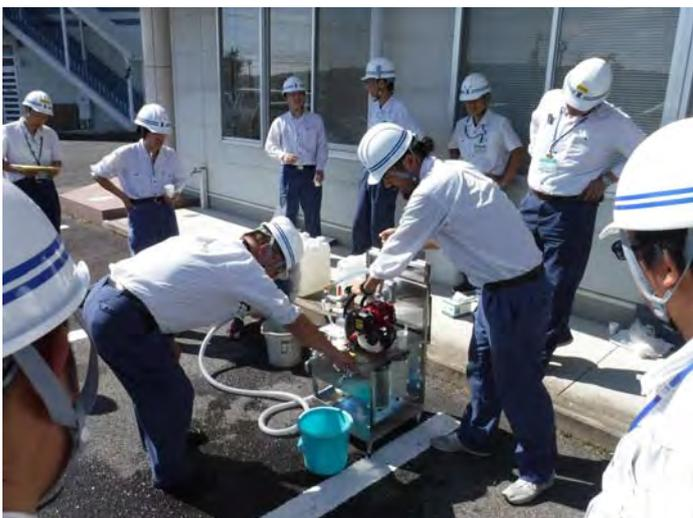
災害対策用浄水器の起動・運転確認の様子
