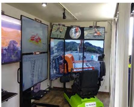
重機を遠隔操作する遠隔施工管理室
