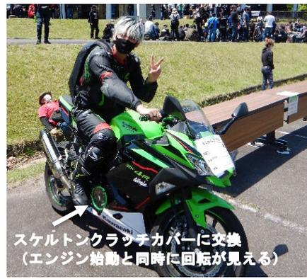
スケルトンクラッチカバーに交換（エンジン始動と同時に回転が見える）
