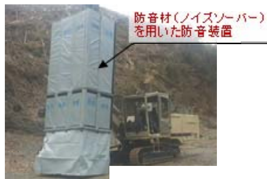
防音装置を装着したクローラドリル(事例)
