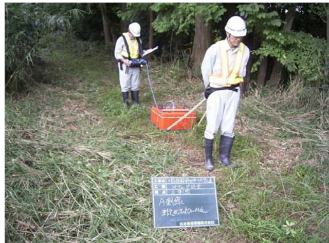
地中レーダー探査測定状況
