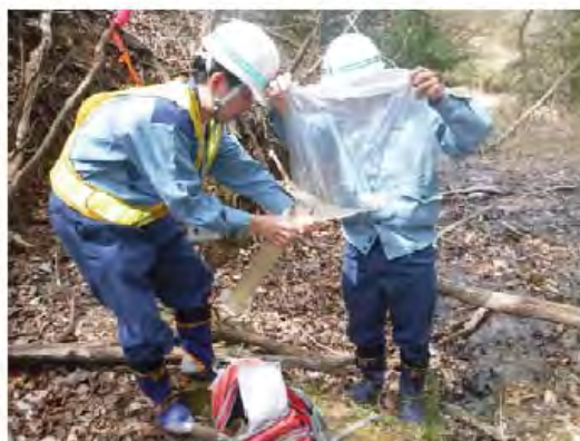
メスシリンダーで湧水量計測
