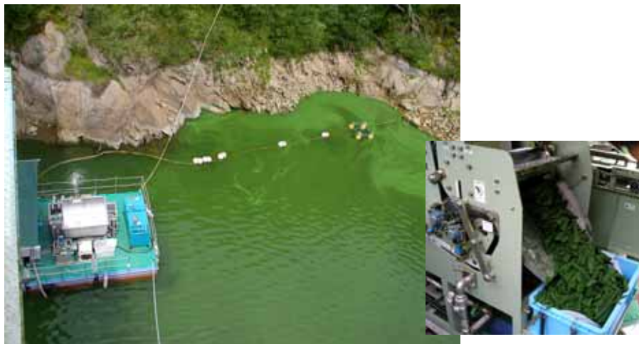
写真 - 2 アオコ回収船と回収されたアオコ (昨年の室生ダムでの実施状況)
