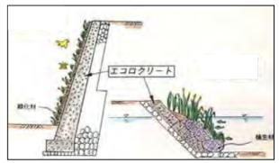
点を置いて造られてきた土木構造物にも、自然環境と調和し、生態系と共生することが近年求められています。エコロクリートは、このようなニーズに応えるため開発された水を透し、緑化ができるエコロジカルなコンクリート " Ecological Concrete " です。
