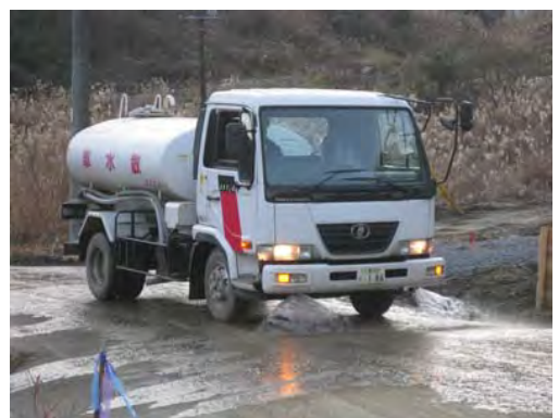
散水車による散水状況
