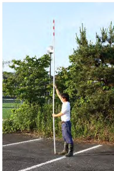
洪水時に川に投げ入れて流れの速さを調査する“浮き”
