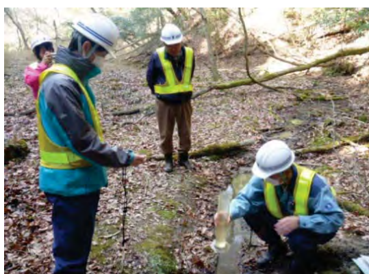
メスシリンダーを使って水量計測
