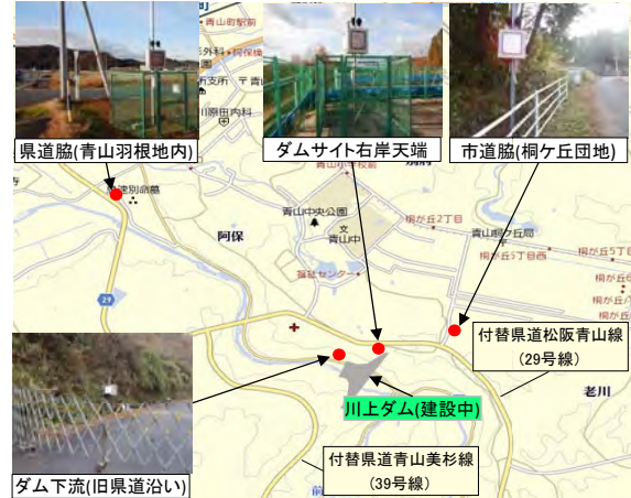
騒音・振動・粉じん計測装置 設置位置
