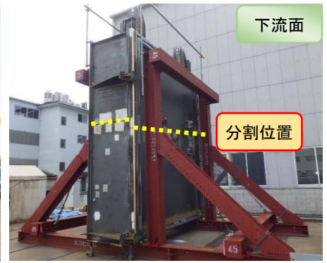
仮組立試験のようす (下流面)
