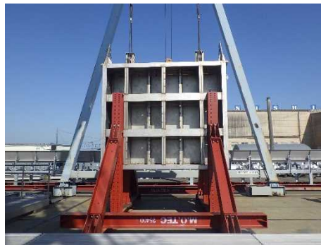
制水ゲートの吊り試験のようす
