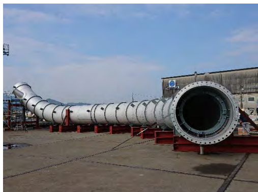
工場にて製作された利水放流管
