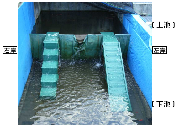
写真3 遡上試験実施状況 (ケースN 壁無し、左岸斜面・右岸階段、流水有り)
