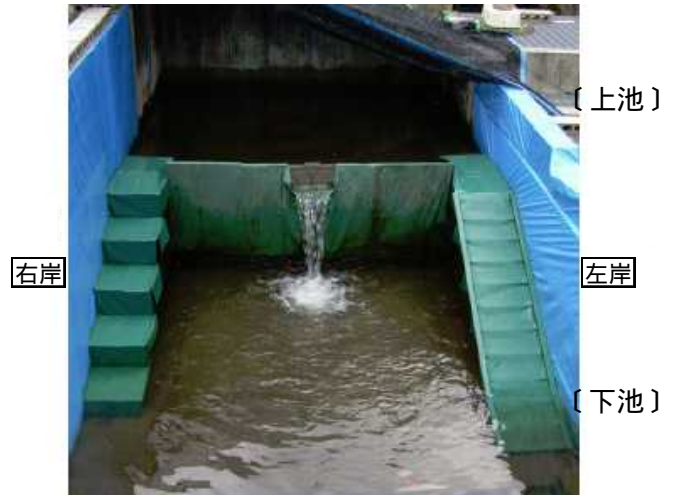
写真2 遡上試験実施状況 (ケースE 壁有り、左岸斜面・右岸階段、流水無し)
