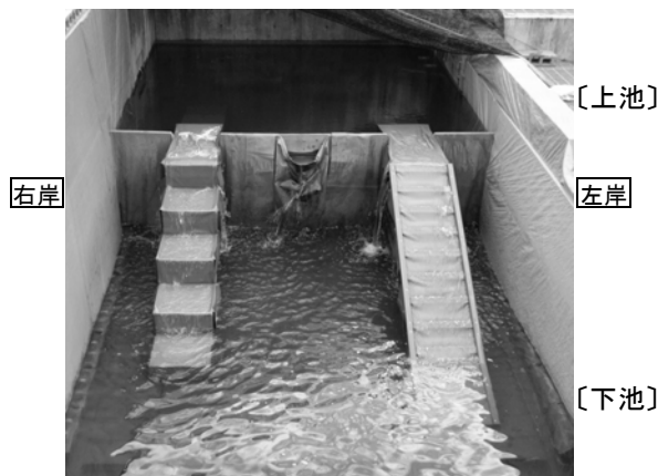
写真-3 遡上試験実施状況 (壁無し、左岸斜面・右岸階段、流水有り)
