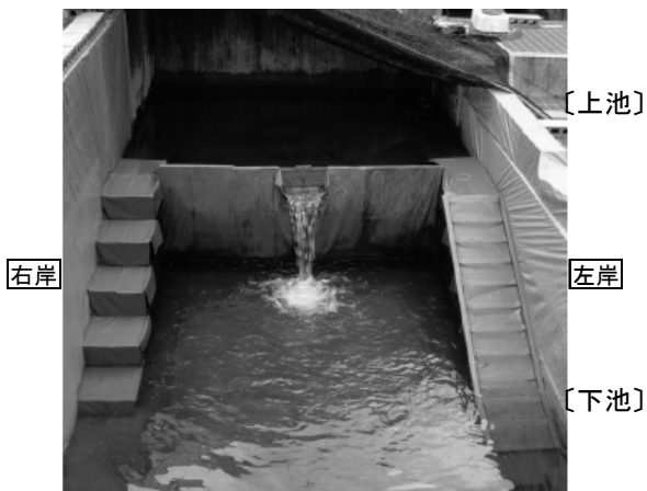
写真-2 遡上試験実施状況 (壁有り、左岸斜面・右岸階段、流水無し)
