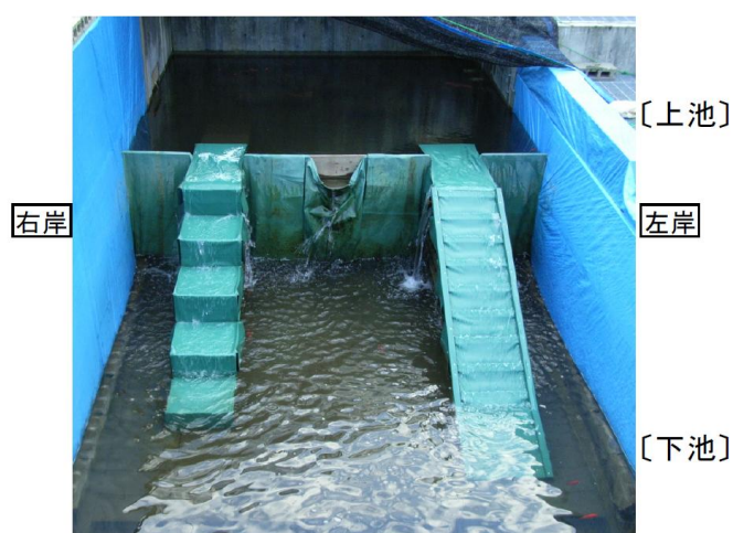
写真 3-23 遡上能力試験の試験ケース例(左:壁有り・流水無し、右:壁無し・流水有り)
