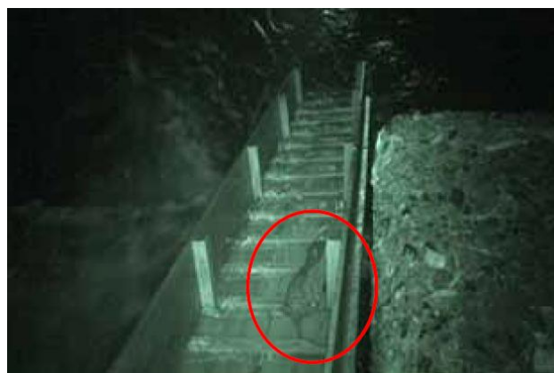
写真 4-8 遡上する様子 (斜面構造)
