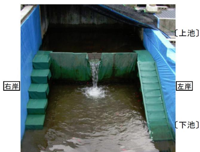
写真 3-23 遡上能力試験の試験ケース例(左:壁有り・流水無し、右:壁無し・流水有り)
