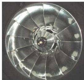
水の流れる方を使ってこの水車をぐるぐる回して電気を作っているんだよ。発電機ではコイルの中で磁石が回って電気を作り出しているんだよ。
