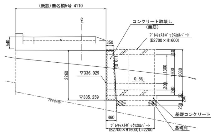
断面図 (2-2) (既設橋下流端) DL=333.00
