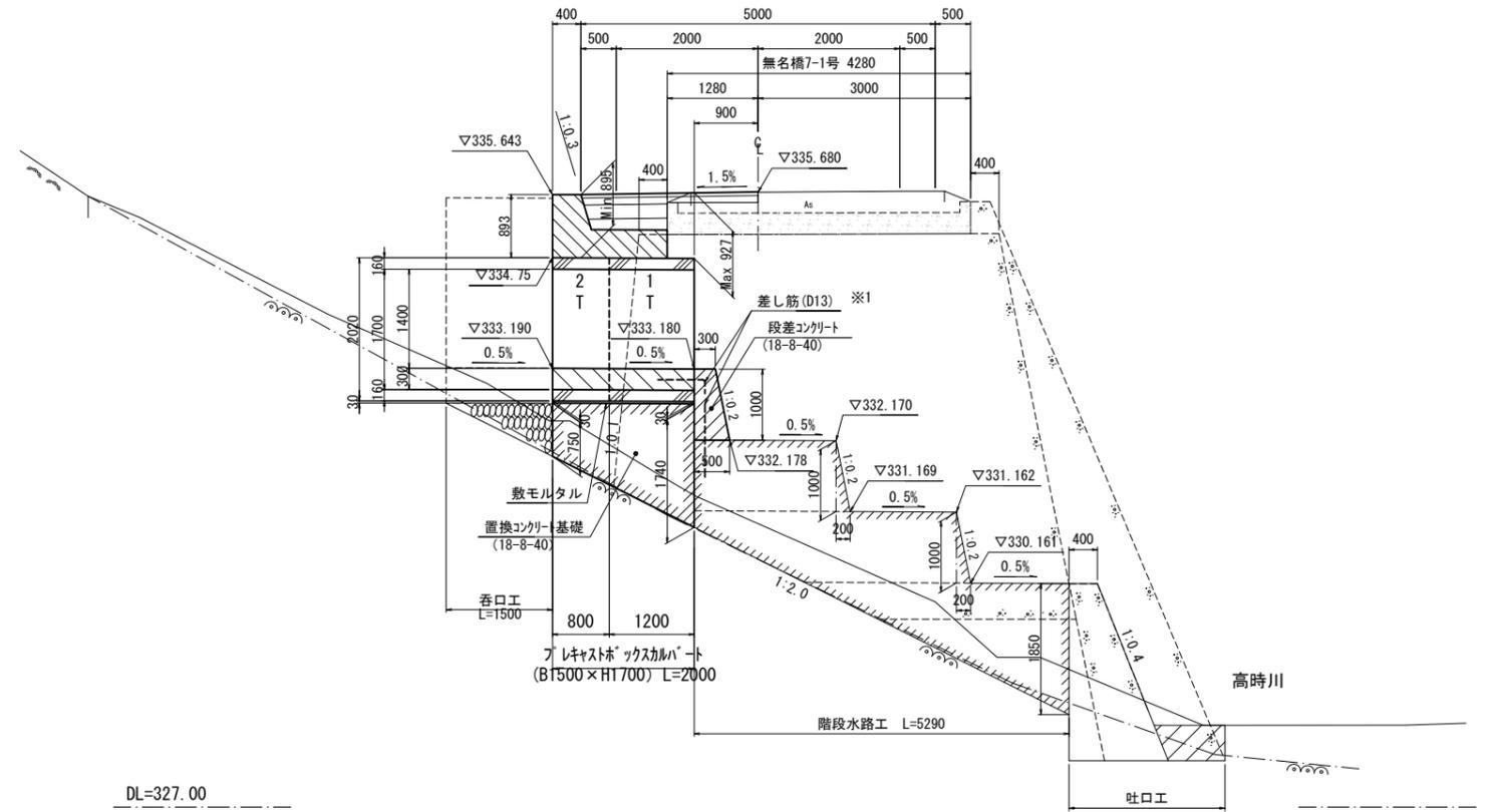
※1. 製品No.1の下流側の段差めコンクリートは、インパットコンクリートおよび階段水路工に差し筋を設けて接続する。
