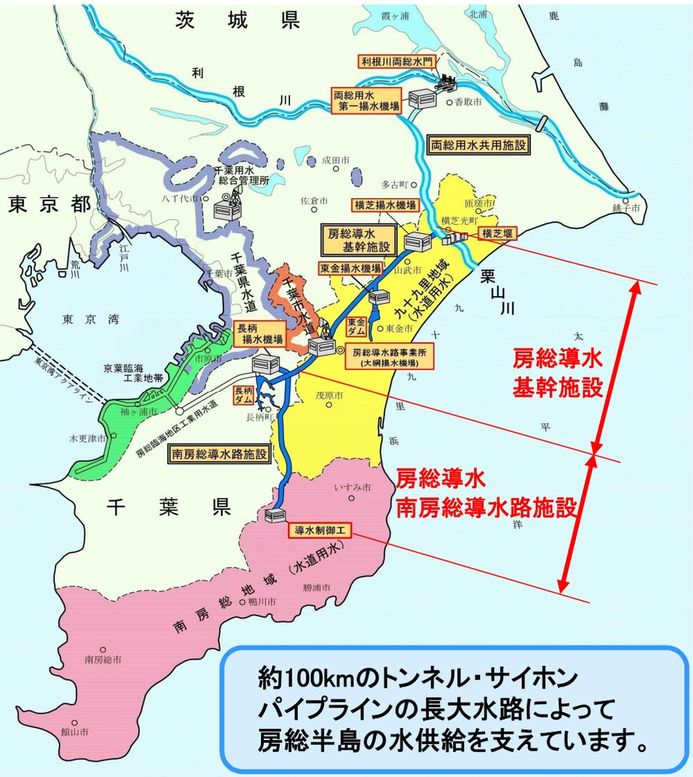
約100kmのトンネル・サイホンパイプラインの長大水路によって房総半島の水供給を支えています。
