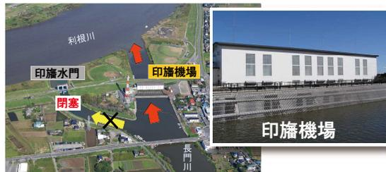
大雨で利根川の水位が上がってくると、昔は利根川の水が印旛沼へあふれてきましたが、現在は印旛水門を閉めて、印旛機場によるポンプ排水を行います。
