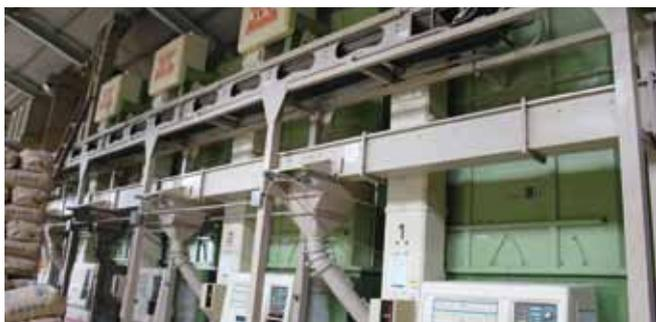
大型機械による乾燥作業
