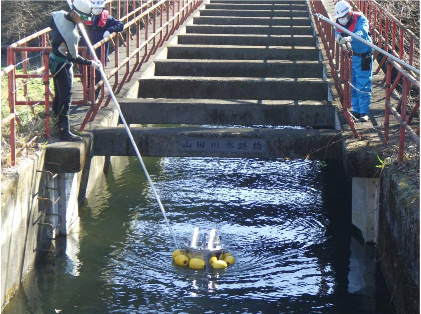
調査ロボットによる水路の機能調査
