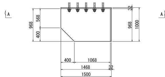
アンカーボルト配置図 縮尺 1:5
