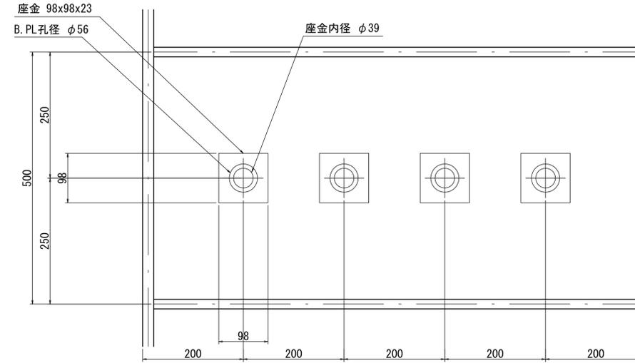
アンカーボルト詳細図 縮尺 1:5
