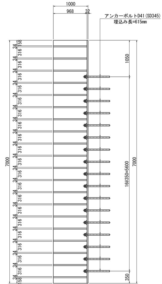
アンカーボルト配置図 縮尺 1:5
