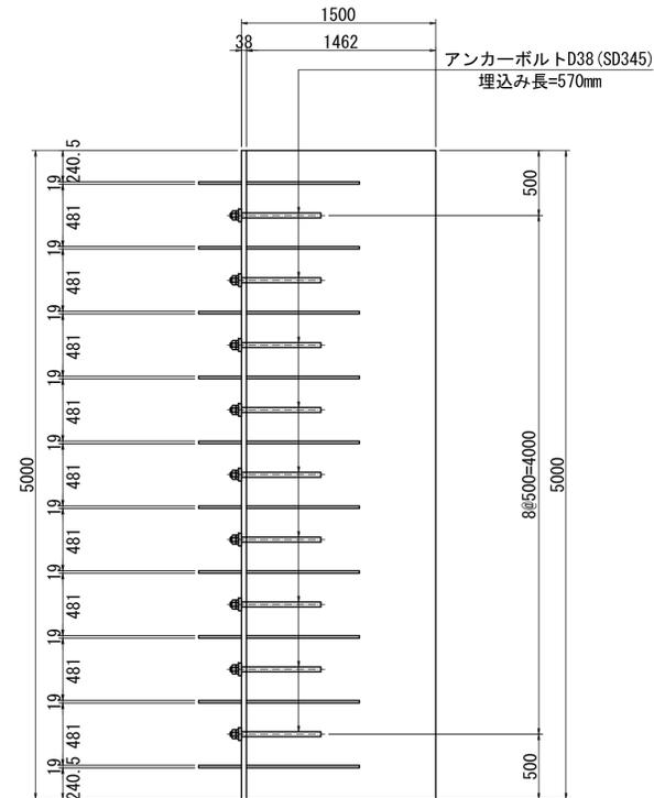
アンカーボルト配置図 縮尺 1:5
