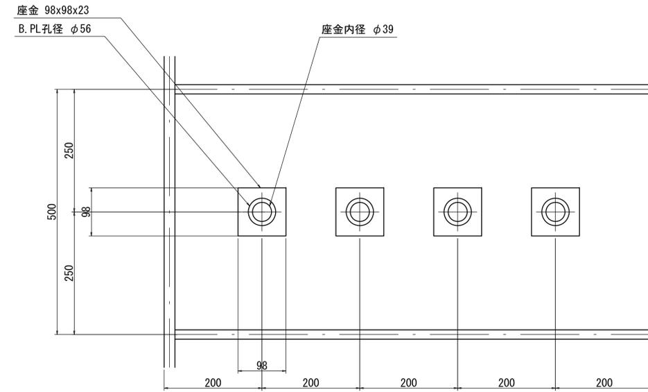
アンカーボルト詳細図 縮尺 1:5
