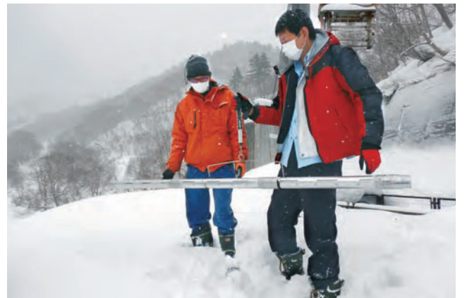
降り積もった雪の密度を測定し、融雪時の水の量を予測します。雪も大切な水源です。
