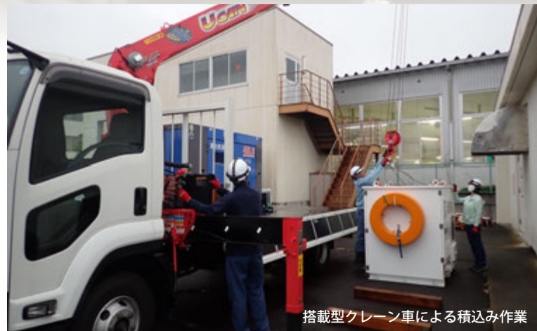
搭載型クレーン車による積み込み作業
