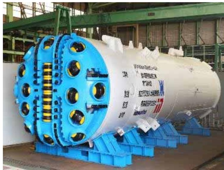
掘削機械(シールドマシン)
