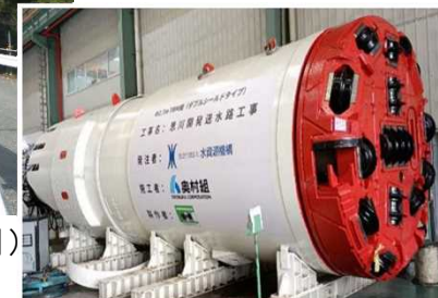
掘削機械(TBM)
