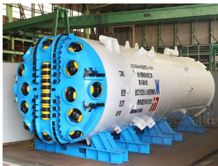
掘削機械(シールドマシン)
