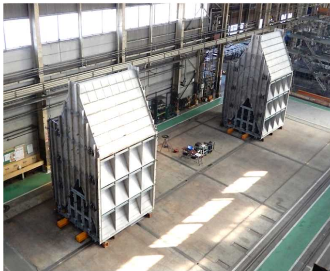
②底部取水管製作完了(受注者工場) (令和4年3月)
