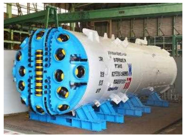
掘削機械(シールドマシン)
