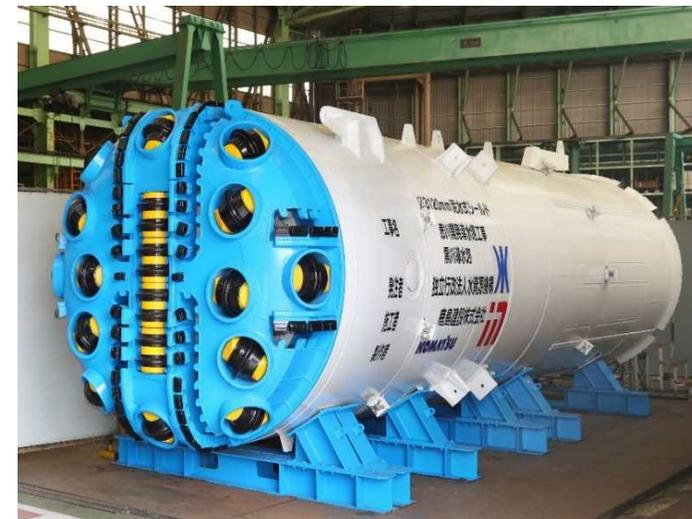
掘削機械(シールドマシン)
