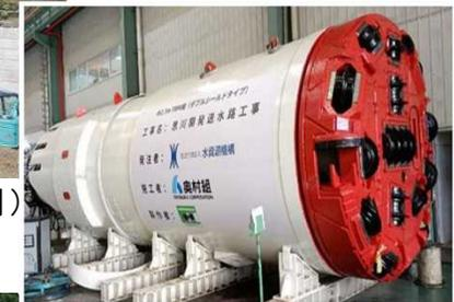
掘削機械(TBM)
