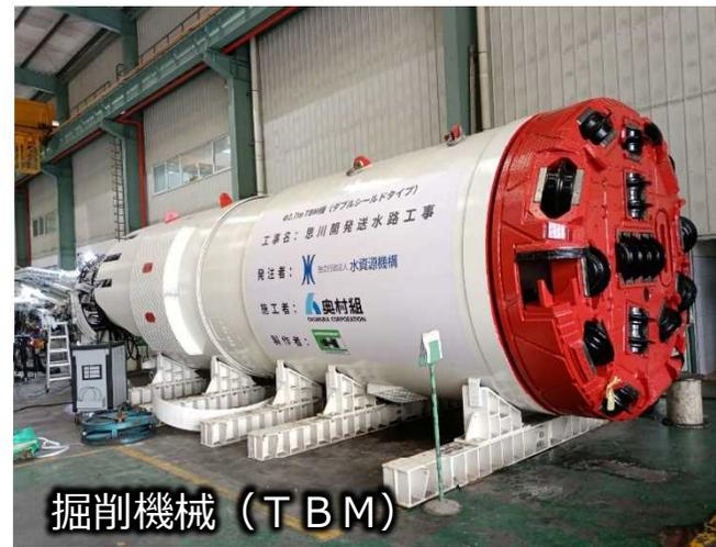
掘削機械 (TBM)
