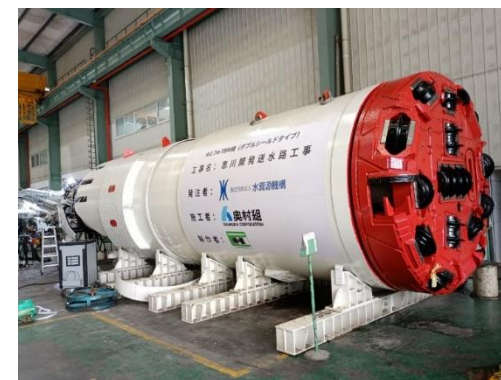
掘削機械（TBM）
