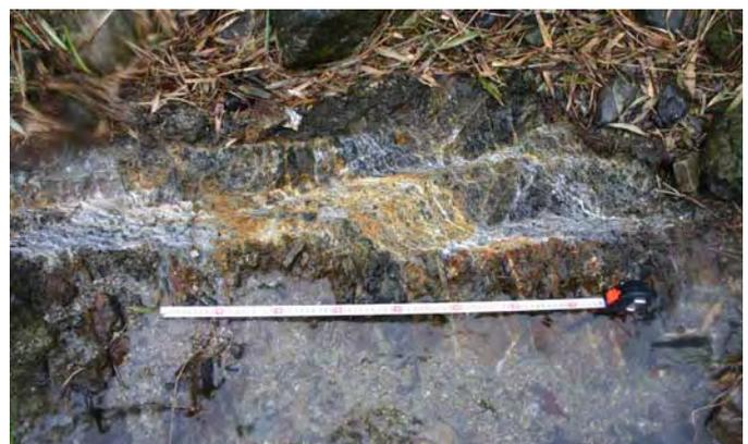
図-6.9 断層露頭における湧水状況 (Fa-2 断層) 図-6.10 粘土を伴う断層破碎帯露頭 (Fa-6 断層)
