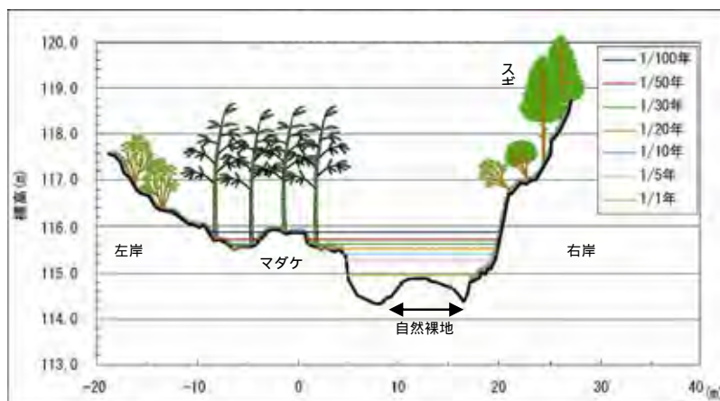
図-10.7(2) 水位計算結果（思川合流点から約1.2kmの南摩川：ダム供用後）
