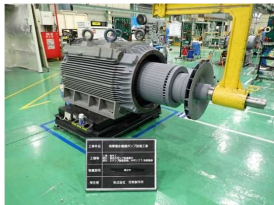
写真-6 中ポンプ原動機
