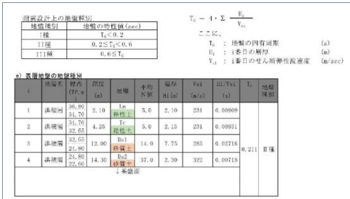
図 1.7. 14 地盤種別の算定 (H27 返田中継水槽耐震照査成果から抜粋)
