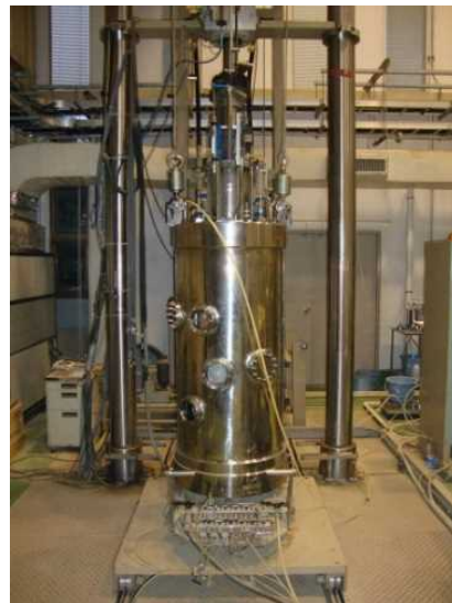
大型三軸試験装置
