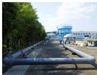
管路の流速係数確認実験
