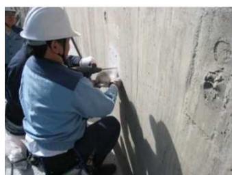
ドリル法による 中性化試験実施状況
