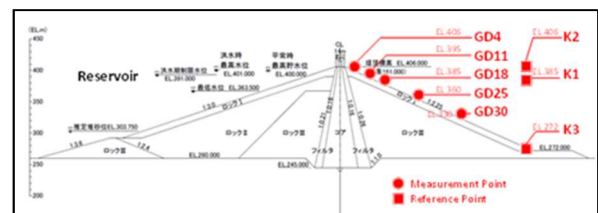
GPS 計測位置断面図（赤丸箇所）
