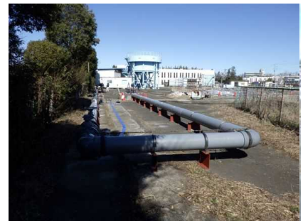
強化プラスチック複合管の流速係数測定実験
