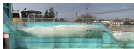
早明浦ダム再生事業水理模型実験 (増設放流管の放流状況)
