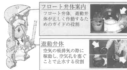
図-1 空気弁の破損状況
