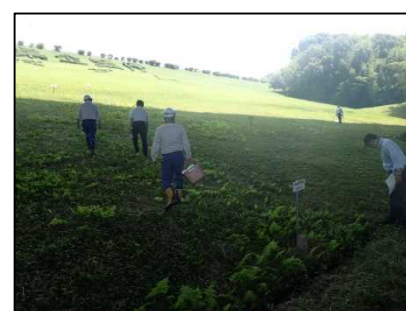
堤体法面の湿潤状況の確認
