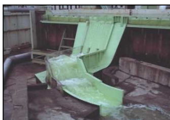
比奈知ダム洪水吐き 模型実験 (縮尺 1/50)
