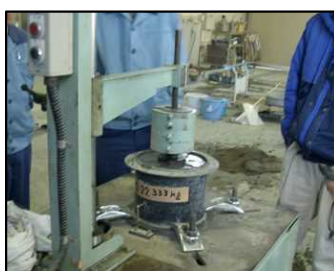
コンクリート配合試験 (VC試験)
