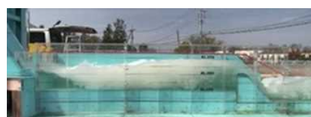
早明浦ダム再生事業水理模型実験 (増設放流管の放流状況)
