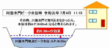
佐間水門の洪水取込による忍川の水位低減効果※1
